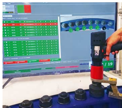
ProTight-Werkerleitsystem und »Digitalisierung 4.0«.
