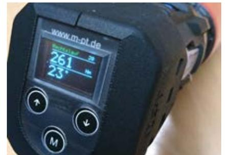
M-PT Matjeschk-PowerTools hat für die Windenergiebranche einen neuen sensorgesteuerten Akkuschauber entwickelt – der MAD-S wurde im April 2020 in den Markt eingeführt. Mit einer Genauigkeit von  $\pm 1,0\%$  über einem Drehmomentbereich von 70–1.400 Nm ist der MAD-S bestens für den Aufbau und die Wartung von Windenergieanlagen geeignet. Weitere Schraubmodelle bis 7.000 Nm sind derzeit in Entwicklung.
