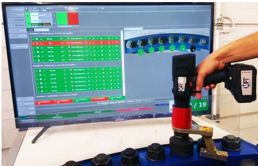
Verschraubung im Werkerleitsystem ProTight™ mit Akkuschauber MAD 20.
