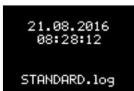
Beim Start des Schraubers werden die aktuelle Uhrzeit und die aktuell geöffnete Datei angezeigt.
